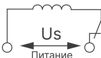
Схема подключения независимого расцепителя РН:
